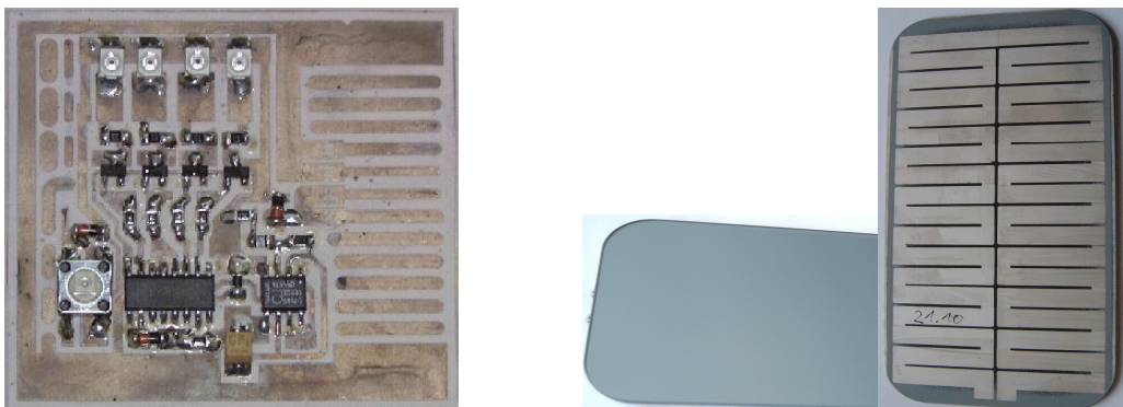
Abb.: strukturiert bedampfte Folie mit Bauelementen bestückt (links) und Heizleiterstruktur (rechts)
